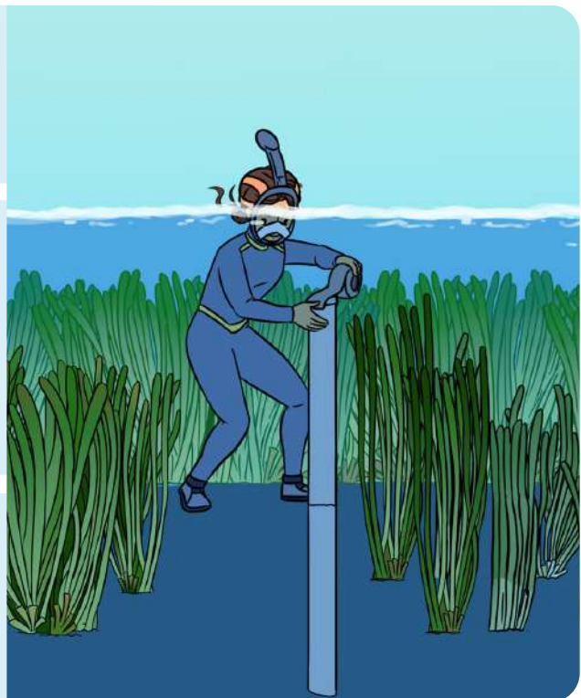
Gambar 6.3. Bagian atas pipa ditutup dan dibungkus dengan lakban
