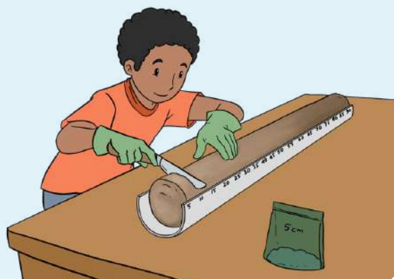
Gambar 6.6. Sampel inti sedimen dipotong setiap 5 cm menggunakan pisau keramik
