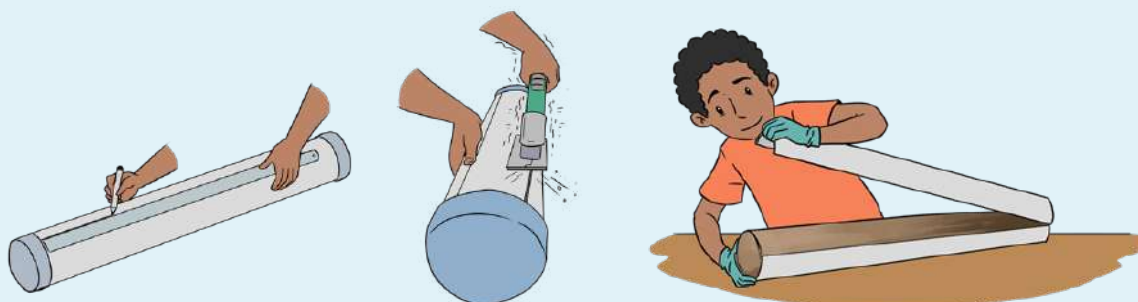
Gambar 6.5 Pipa dibelah dengan gerinda
